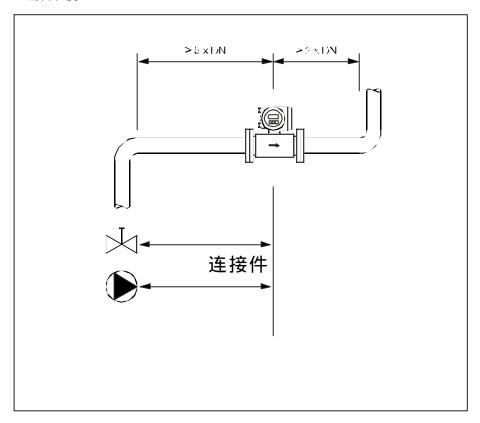
借助合适的连接件遵守DIN 28545 (缩径管和扩大管) 能在较大直径的管道上使用。对于流动较慢的液体,所产生的较高速度可增加测量的精度。这里所示的曲线图显示能被用于计算缩径和扩径引起的压力损失。这个曲线表图仅适用于粘度与水接近的液体。
